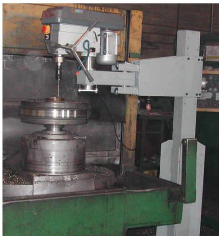
Montaje de taladro de columna para el taladrado de engrasadores en ruedas dentadas mecanizadas sobre torno vertical CNC.
