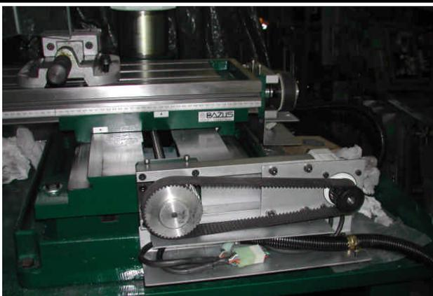
Adaptación de los Servomotores AC con encoder integrado en una máquina.
