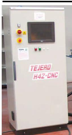
Armario de mando con PC integrado para la programación de curvas complejas.
