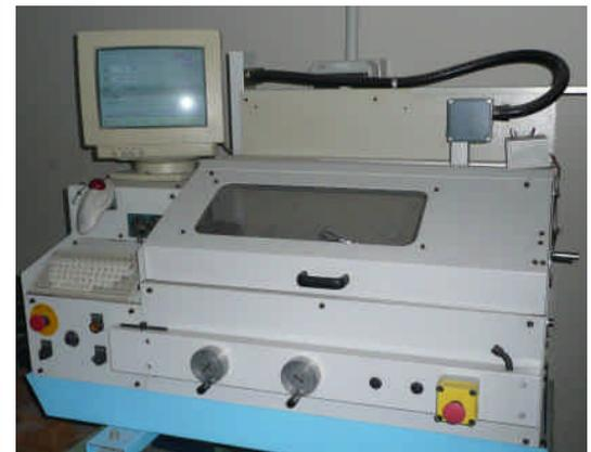
Torno de sobremesa con CNC basado en PC y software Dyfe-CAD/CAM para centro de formación. Motores Brushless, cabezal velocidad variable.
