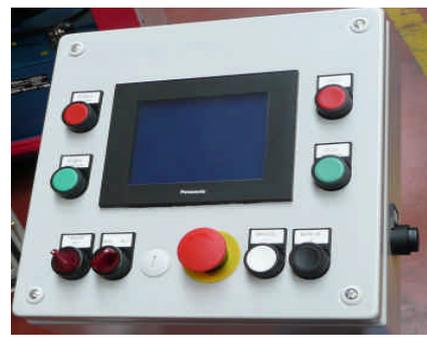
Pantalla táctil para el control del operador de la máquina.
