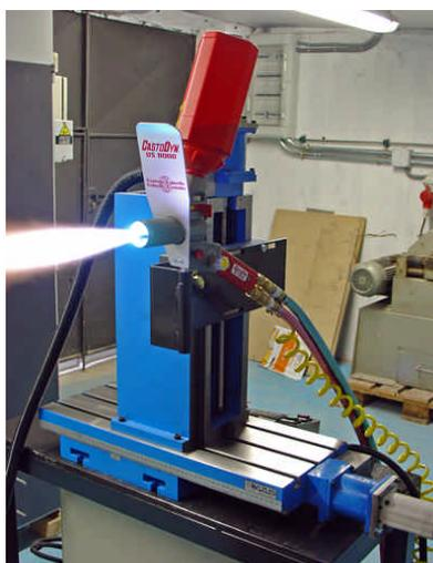
Automatización de tratamiento térmico de vidrio con mesa BAZUS de 2 ejes uno vertical y otro horizontal.
