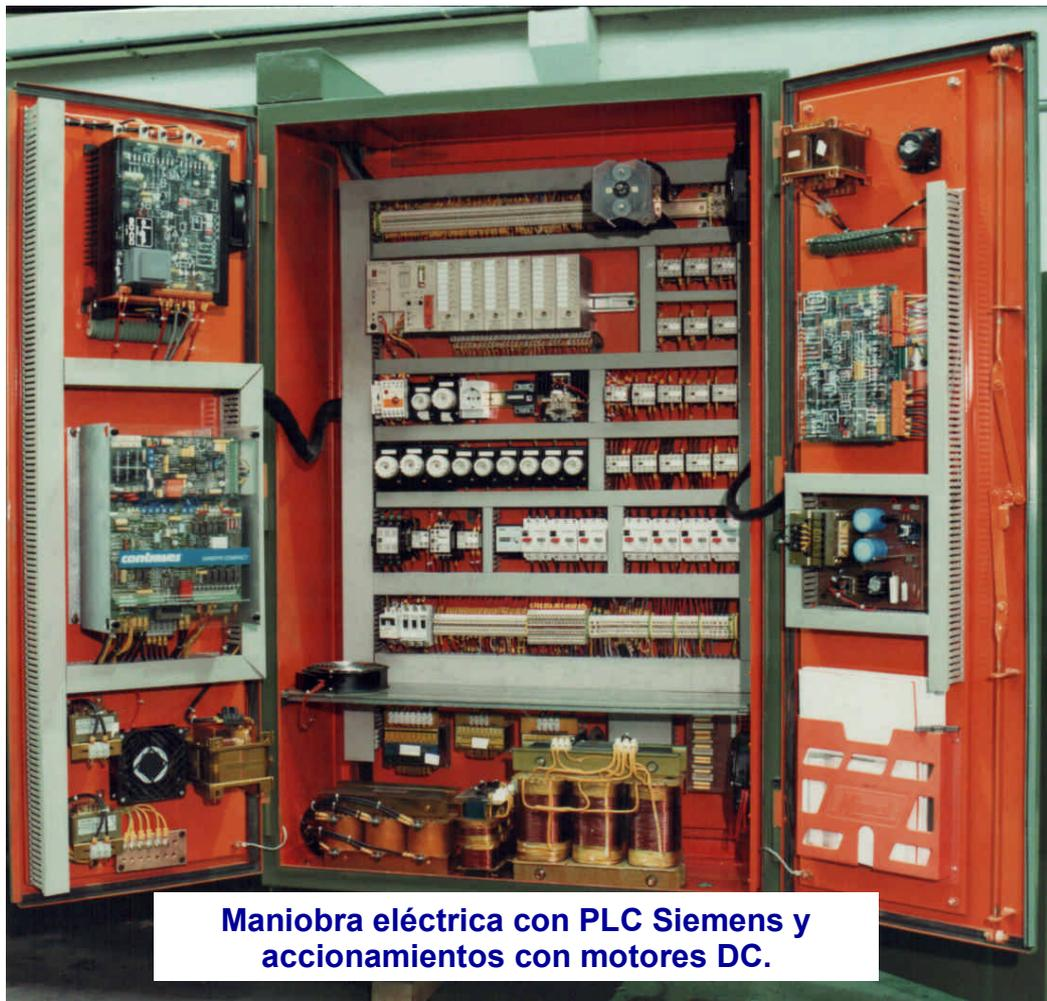
**Maniobra eléctrica con PLC Siemens y accionamientos con motores DC.**
